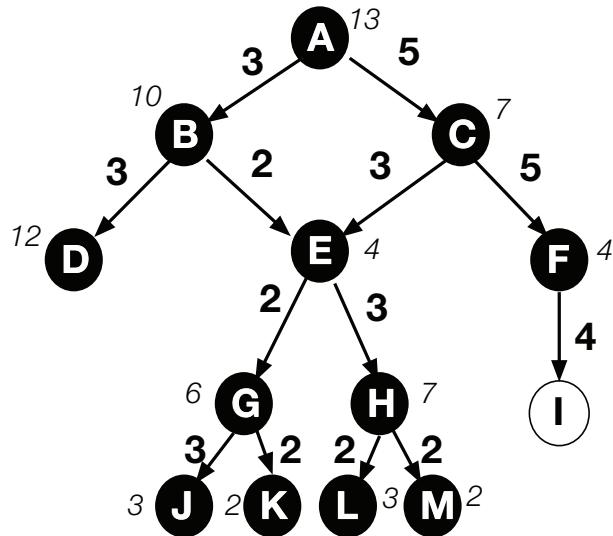
Les arcs indiquent la génération des noeuds par la fonction de successeur. On suppose que les successeurs sont générés dans un ordre de gauche à droite. Les chiffres à coté des arcs donnent les coûts et ceux à coté des noeuds les valeurs d'une fonction heuristique. Le noeud initial est le noeud A. Il y a un seul noeud but, I.
