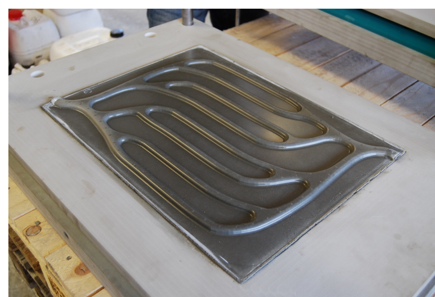
Abb. 3: Durchführung des ersten Membran-Vakuumtiefziehversuchs mit UHPC: a) Auftragen des UHPC, b) FracTherm®-Struktur nach Tiefziehen, c) Abziehen der ebenen Platte, d) Zusammenfügen von Ober- und Unterteil (UHPC noch frisch)
