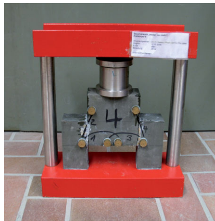
Bild 7. Prüfeinrichtung für die Dauerstandversuche nach Tabelle 5
