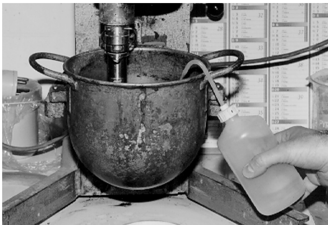
Fig. 2.10 - Ajustement de l'eau dans l'essai de demande en eau
