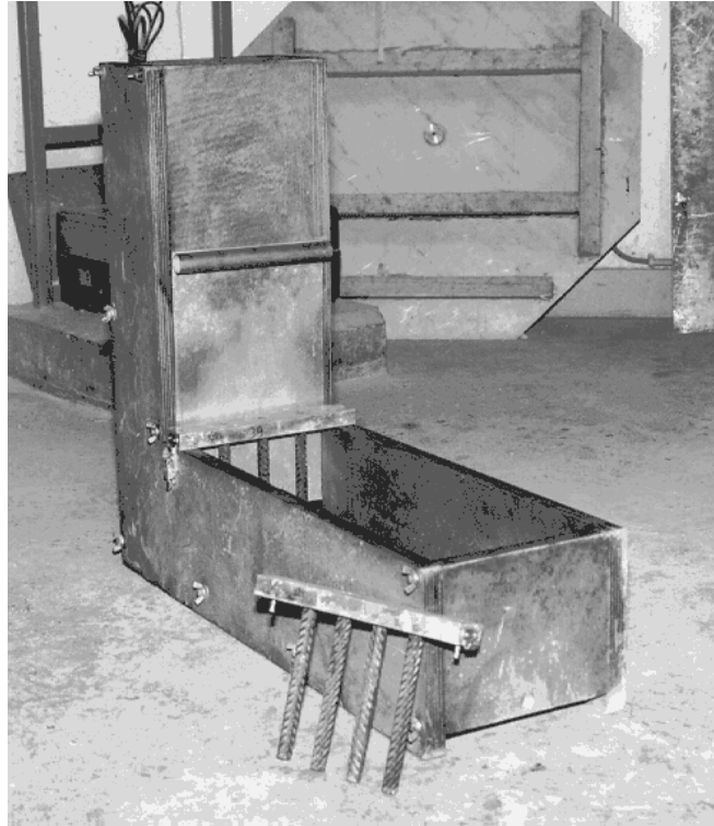
Fig. 3.1 - Boîte en L: la trappe métallique coulisse verticalement. On peut modifier le jeu d'armatures
