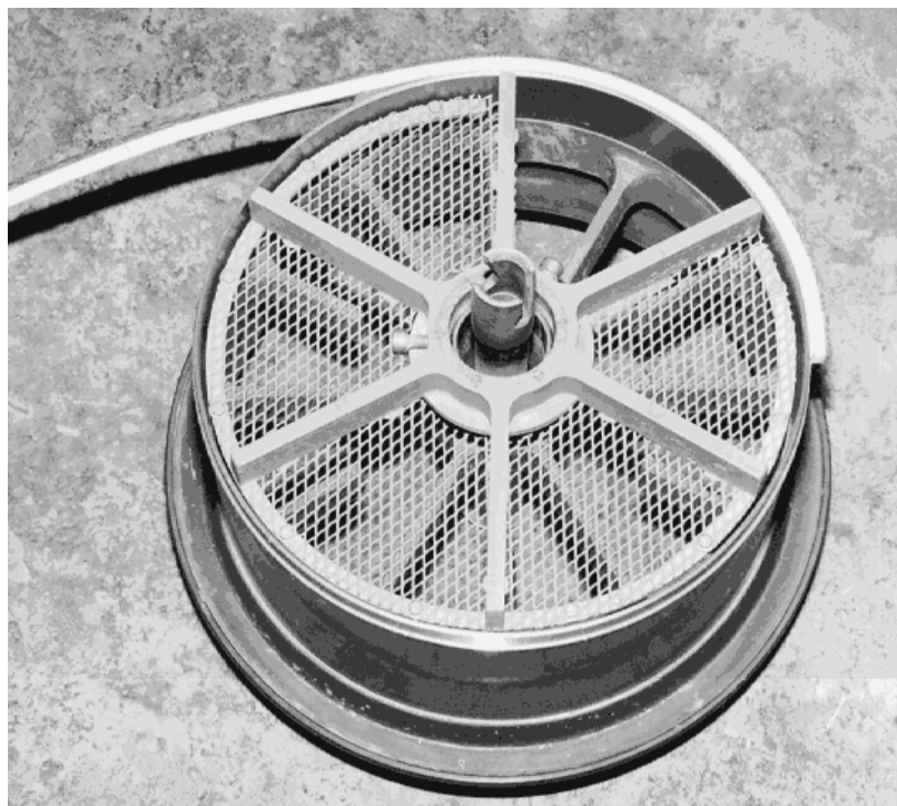
Fig. 3.15 - La pale supérieure équipée d'une grille est vissée sur la partie en rotation. Le béton est introduit par la fenêtre sans grillage. Le joint est en cours de collage sur la partie tournante.
