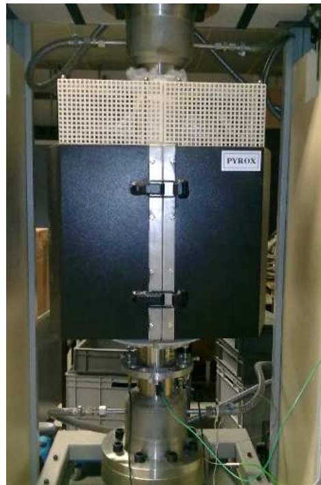
FIGURE 4.1: Vue du dispositif expérimental haute température, en position fermée.
