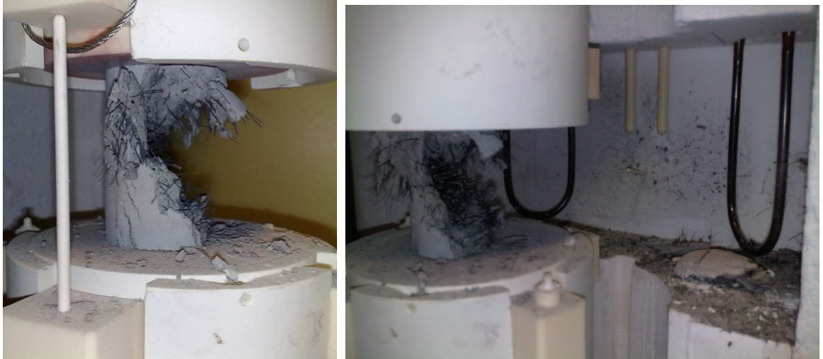
FIGURE C.3: Reste de l'échantillon CSB6.35_9_1480 à l'issue de l'essai en compression simple à 750°C
