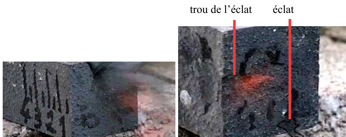
FIGURE 2.27: Éclatements se produisant lors d'un essai.
