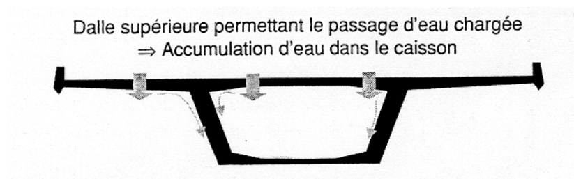
Figure 4 - Pénétration d'eau par des fissures traversantes dans un élément de caisson de pont, d'après Laurencet (1999).
