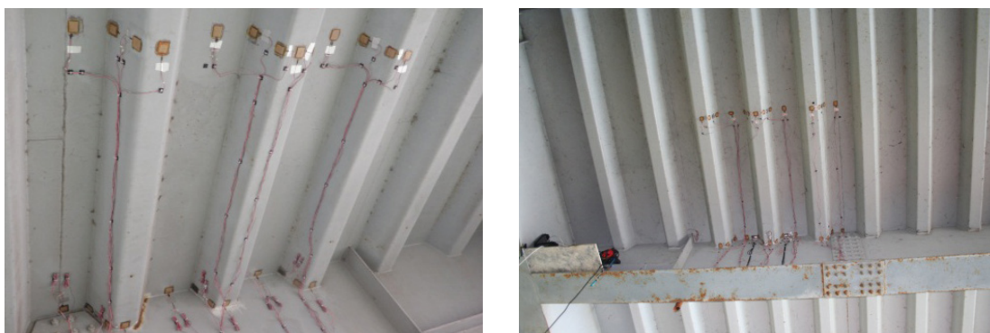
Figure 16 : instrumentation du platelage
