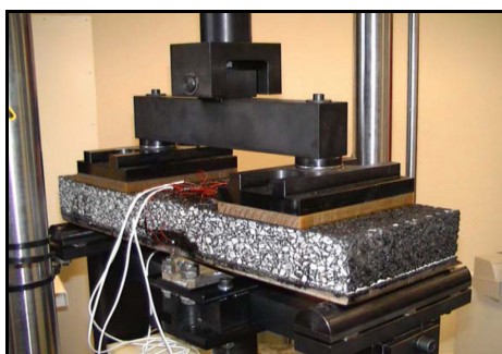
Figure 8 : dispositif de l'essai de flexion 5 points. à gauche : photo ; à droite : schéma descriptif
