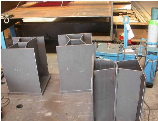
Figure 11a : éprouvettes avant mise en place de la connexion
