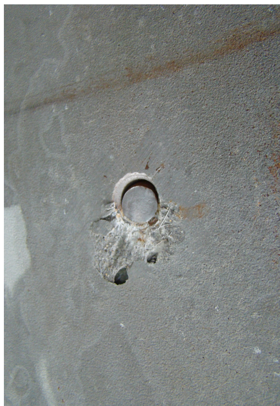
Figure 14 : essai Push-out avec goujons - ruine par cisaillement des goujons
