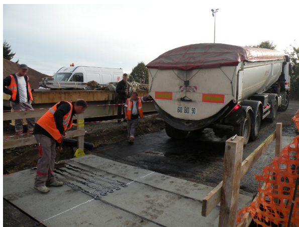
Figure 2 : pose du revêtement Orthochape® sur le corps d'épreuve
