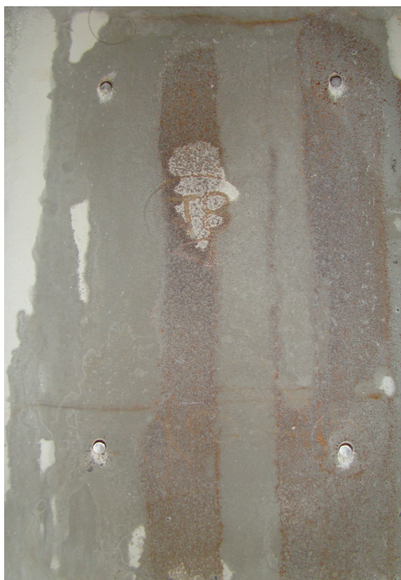
Figure 14 : essai Push-out avec goujons - ruine par cisaillement des goujons
