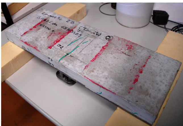
Figure 9 : comparaison visuelle de la fissuration sur la surface supérieure du revêtement sous un chargement de 40 kN à 2 millions de cycles pour les 2 types de connexion : à gauche treillis, à droite goujons
