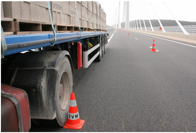
Figure 8 : photos prises lors du chargement du viaduc de Millau à gauche : chargement statique en octobre 2009 ; à droite : charge roulante en octobre 2010
