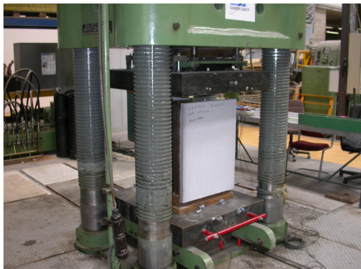
Figure 12 : presse d'application du chargement - Essais Push-out
