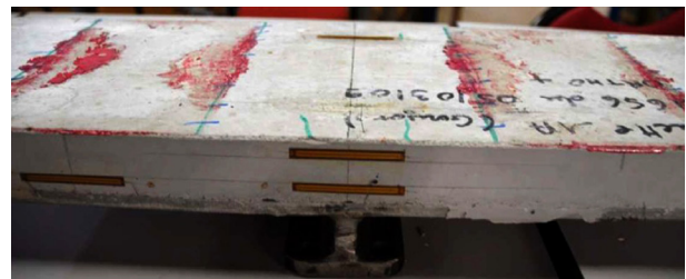
Figure 9 : comparaison visuelle de la fissuration sur la surface supérieure du revêtement sous un chargement de 40 kN à 2 millions de cycles pour les 2 types de connexion : à gauche treillis, à droite goujons
