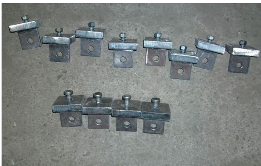
Figure 19 : principe et éprouvettes Pull-out pour les essais d'arrachement
