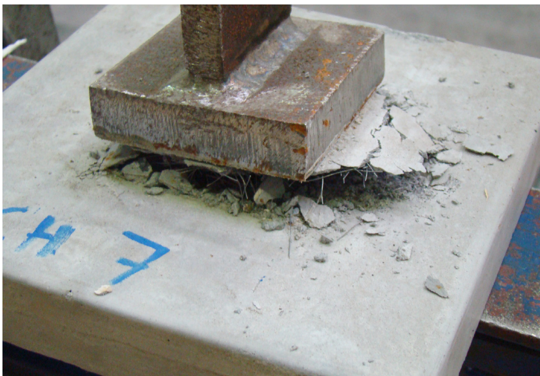
Figure 20 : mode de ruine des éprouvettes au cours des essais d'arrachement
