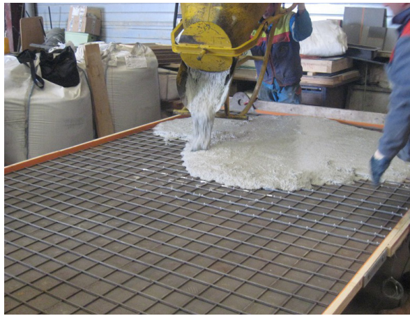
Figure 4 : coulage de la couche de BFUP sur le corps d'épreuve
