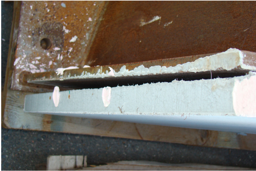
Figure 15 : essai Push-out avec Treillis Soudés - ruine par désolidarisation BFUP-Platelage
