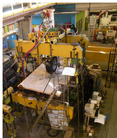
Figure 7 : vue du montage en configuration plaque(s) et roue(s)
