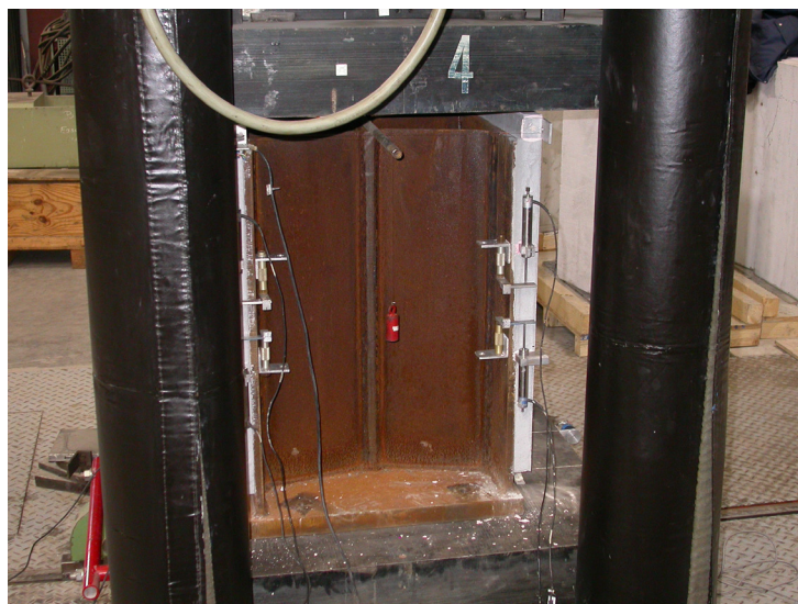
Figure 13 : mesures du glissement par capteurs de déplacement
