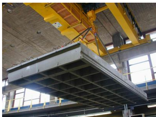
Prototype de dalle de pont en Béton Fibré à Ultra hautes Performances sur la plateforme d'essai des structures du LCPC
