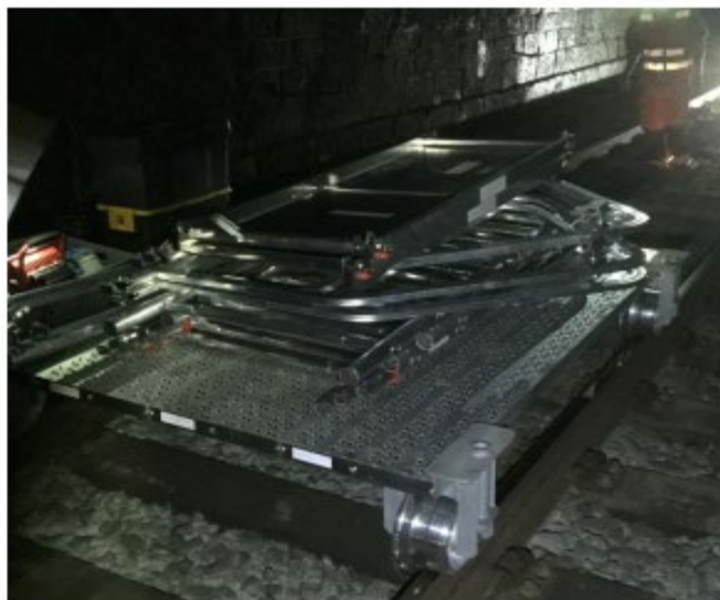
figure 1: échafaudage transportable avec l'équipe de mesure (profil radial en jaune) et chariot de transport en rail
