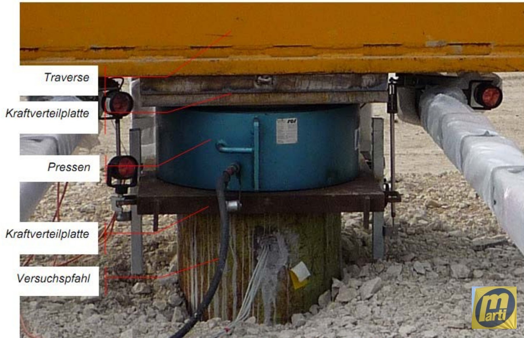
Ansicht der Belastungseinrichtung am Versuchspfahl, Pressen
