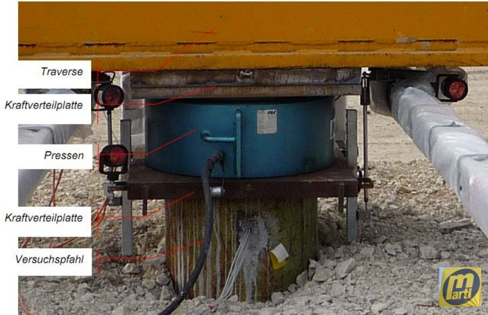
Ansicht der Belastungseinrichtung am Versuchspfahl, Pressen
