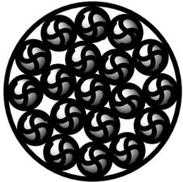
⇒ Colonne garnie à phase stationnaire sous forme de billes de gel poreux.
