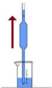
Rincer la pipette en prélevant la solution au-dessus du trait de jauge. Vider le contenu dans un bécher déchet. Si nécessaire, recommencer.
