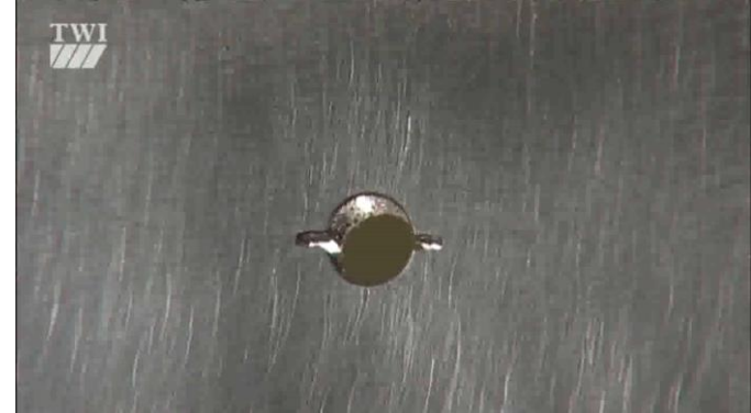
Propagation de fissure à partir d'un défaut
