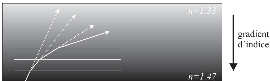
FIGURE 1.4 – Lorsqu'il existe un gradient d'indice de réfraction (milieu inhomogène) la lumière ne se propage plus en ligne droite. Tel est le cas dans une cuve remplie de glycérine ( n = 1.47 ) et d'eau ( n = 1.33 ).
