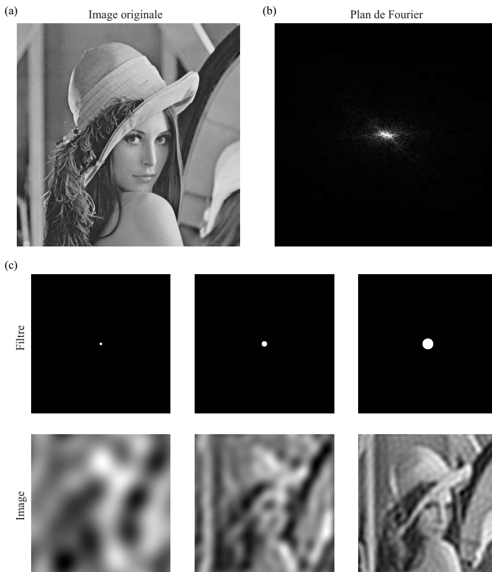
FIGURE 3.17 – Filtrage avec un système 4f : (a) image originale, (b) spectre dans le plan de Fourier et (c) effet de différents filtres passe-bas (la partie qui transmet la lumière est indiquée en blanc).
