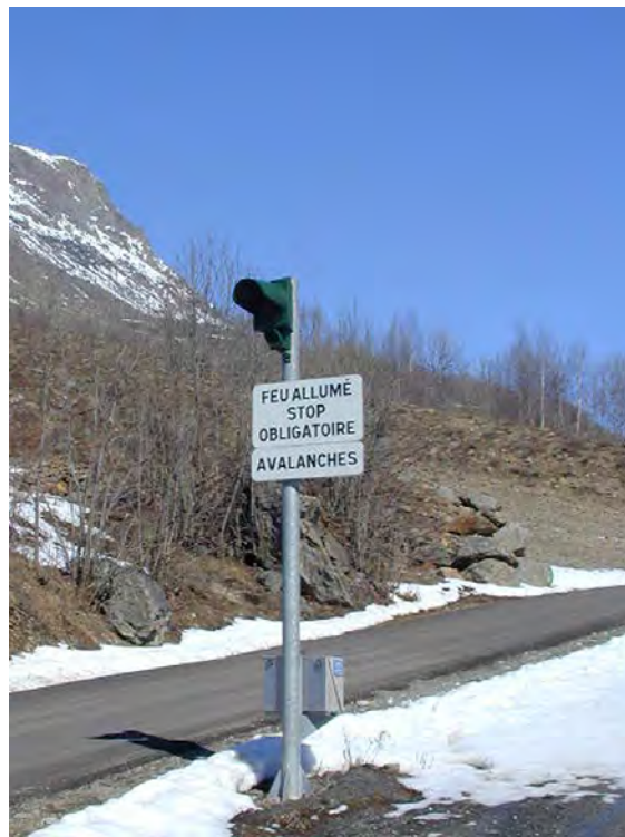
Figure 3.13 – Feu de signalisation d’un détecteur routier d’avalanche (ici sur la route départementale menant à Clavans, Isère).
