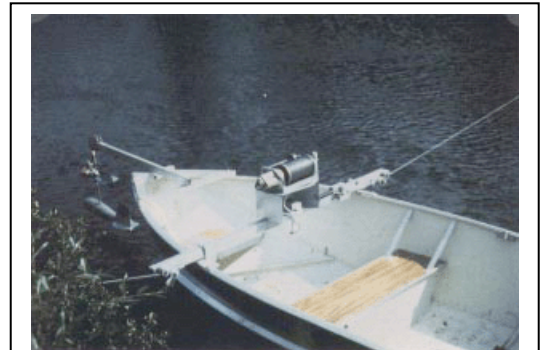
Figure 13. Châssis pour sondage fixé à la proue d'une embarcation de type Saskatchewan
