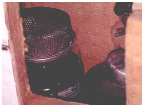
Figure 20. Isolation et réchaud catalytique à l'intérieur de la caisse chaude
