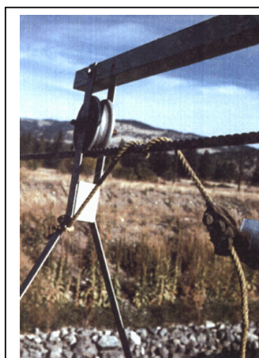
Figure 24. Corde de freinage employée de façon à varier la vitesse
