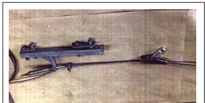
Figure 53. Dispositif de protection contre les chutes de type coulissant
