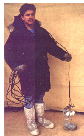
Figure 17. Corde à main en kevlar avec le saumon et le moulinet
