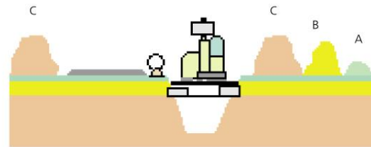
5. Excavation de la tranchée
