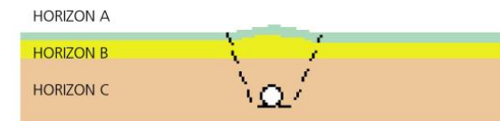
9. Remise en état final et ensemencement
