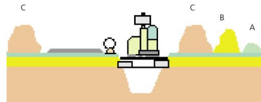
5. Excavation de la tranchée
