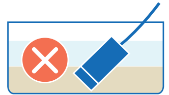
Illustration 2: Montage de la pompe, la pompe ne doit pas être dans la boue
