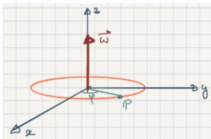
Soit  $\vec{\omega}$  le vecteur de norme  $\omega$ , perpendiculaire au plan contenant le cercle décrit par  $P$  et de sens donné par la règle du tire-bouchon.
