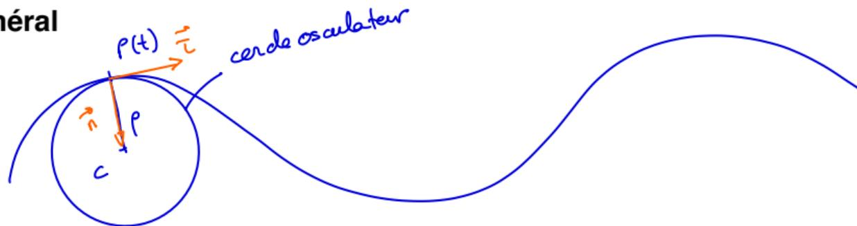
Soit le cercle osculateur à la trajectoire au point considéré. Il a un rayon  $\rho$ . Soient  $\vec{t}$  tangent à la trajectoire dans le sens du mouvement et  $\vec{n}$  pointant vers le centre du cercle osculateur, tous deux unitaires.
