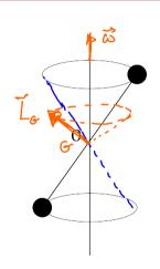
dorsque le volide tourne au tour de (63) le moment enétique La varie (sadvection change).  $\overline{Z}\overline{J}_{\sigma}^{eff} = \frac{d\overline{L}_{\sigma}}{d\overline{L}} \neq \overline{O}$  En général, le moment cinétique n'est pas parallèle à l'axe de rotation. Sauf si il y a une certaine symétrie dans la répartition de la masse :
