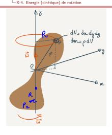
Chaque "worce au " du solide déorit un cerde au hor de l'are Oz à la vitesse Rw arec R: distance P-are worceau de solide: volume dV masse dm =  $\rho(\vec{r})$ .dV  $dE_{c,rot} = \frac{1}{2} dm (R\omega)^2 = \frac{1}{2} \rho(\vec{r}) dV R^2 \omega^2$ Econol = Super during = 1 we Super du
