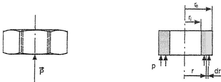
Fig. 3.34 Répartition de la pression sous l'écrou.
