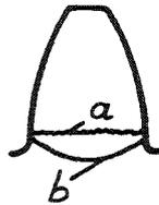
**Fig. 6.81** Rupture de dent.
