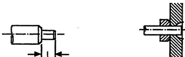
Fig. 4.17 Axes avec épaulement pour guidage axial.
