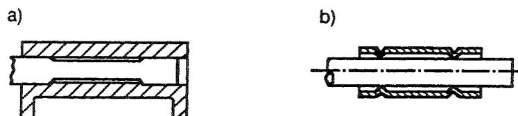
Fig. 4.32 Guidages rectilignes avec dégagement.
