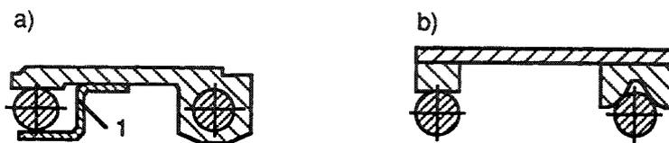
**Fig. 4.33** Guidage d'un chariot par 2 axes.
