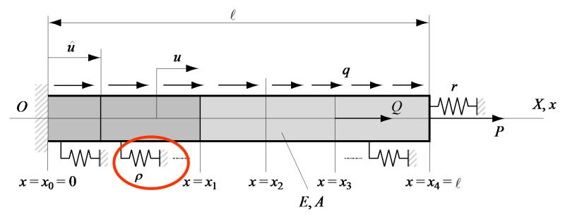
• Modification de l'équation différentielle : ajout d'une charge axiale  $\rho u$  proportionnelle au déplacement axial u
