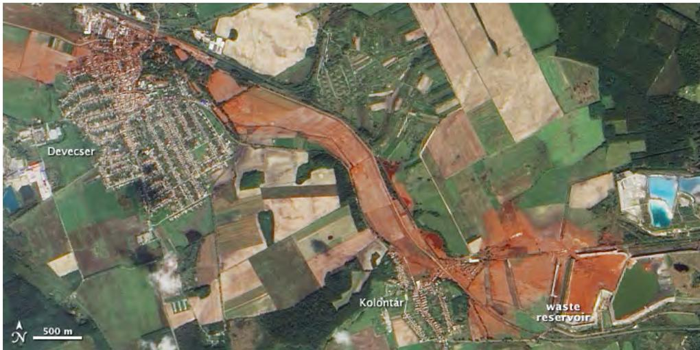
**Figure 2.41** – Zones inondées par la rupture du bassin de décantation de l’usine d’Akja en Hongrie. Photographie satellitaire prise le 9 octobre 2010. Source: [NASA](#).
