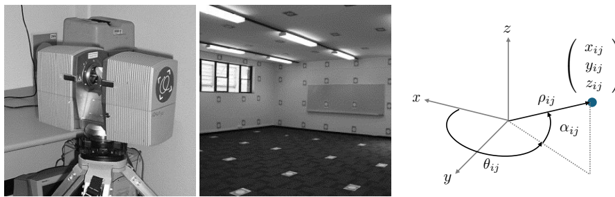
Figure 1: Scanner laser (gauche), cibles de contrôle (centre), observations (droite).
