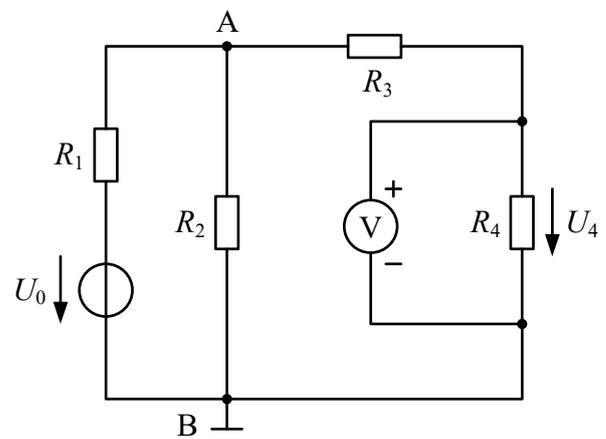
Réaliser les montages et mesurer les 3 tensions  $U_2$ ,  $U_3$  et  $U_4$  à l'aide du multimètre **HMC8012**.
