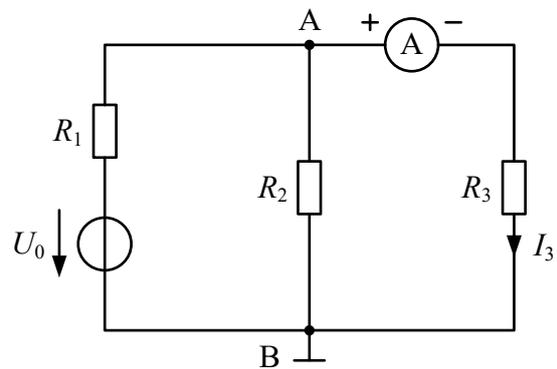
Réaliser les montages et mesurer les 3 courants  $I_1$ ,  $I_2$  et  $I_3$  à l'aide du multimètres **HMC8012**.
