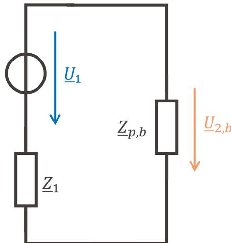
Objectif: Calculer la tension aux bornes de  $\underline{Z}_2$  et le courant correspondant
