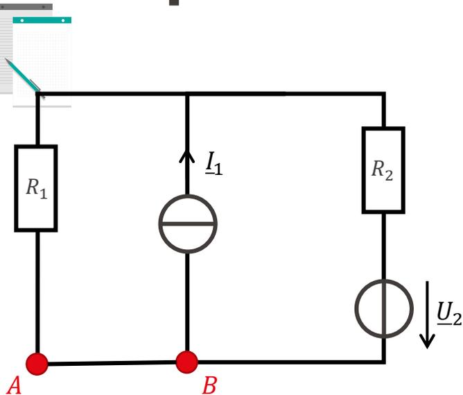
Retrouvons le résultat du courant de court-circuit de la source équivalente de Norton par transformation de source:
