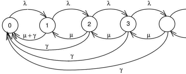
FIGURE 4 – Processeur de type M/M/1 avec pannes : diagramme des transitions.
