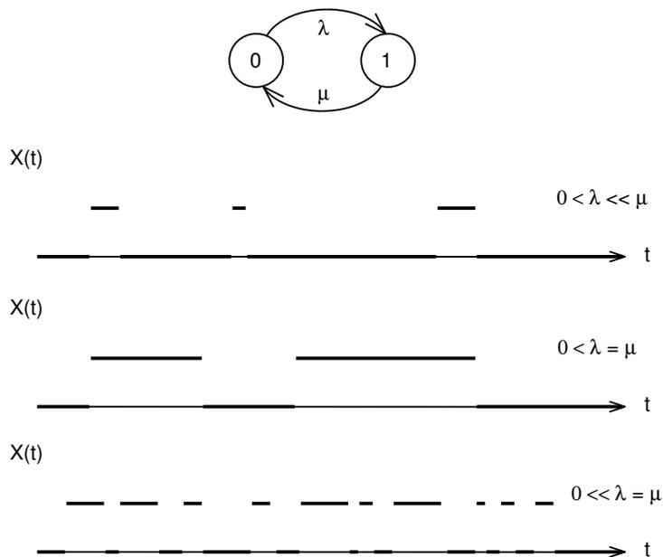
FIGURE 1 – Chaîne de Markov à deux états : diagramme des transitions, et quelques trajectoires typiques pour certaines valeurs de  $\lambda$  et  $\mu$ .
