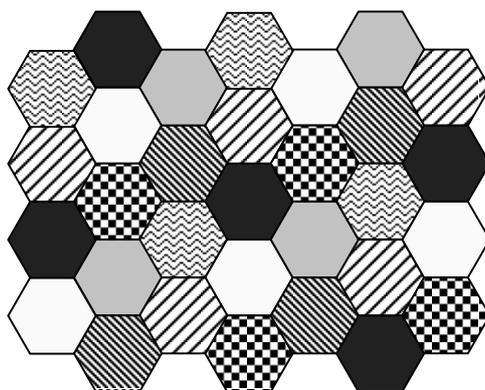
FIGURE 6 – Assignment de canaux fixes dans un système cellulaire avec réutilisation de 7 groupes de fréquences différentes.
