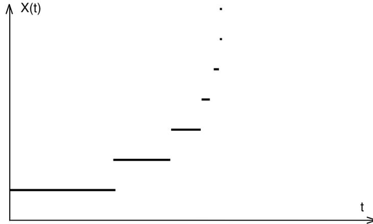
FIGURE 2 – Une trajectoire typique d’un processus de naissance pure avec explosion en un temps fini.
