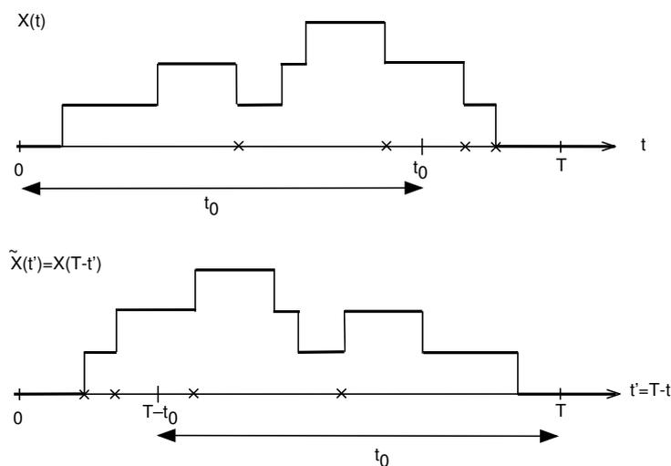
FIGURE 5 – Une trajectoire de la chaîne directe d’un processus M/M/1 (en haut) et la trajectoire du processus renversé (en bas). Les croix marquent les instants de départ de clients dans le processus direct, et donc d’arrivées de clients dans le processus renversé.
