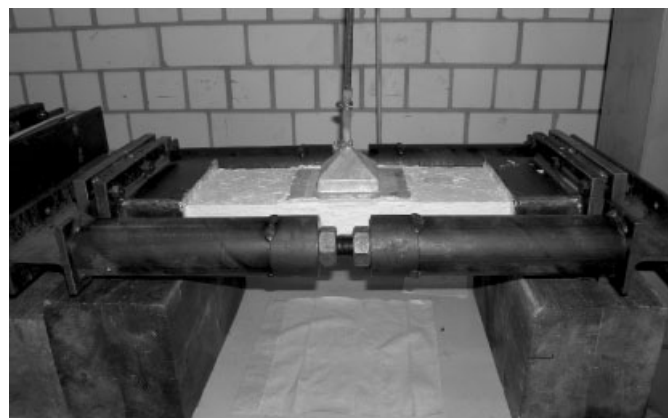
Bild 3. Beaufschlagung der Sifcon-Probekörper im gedehnten Zustand
