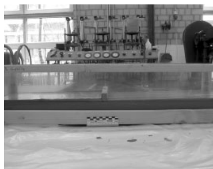
Bild 9. Herstellung eines stufenförmigen Gefälles
