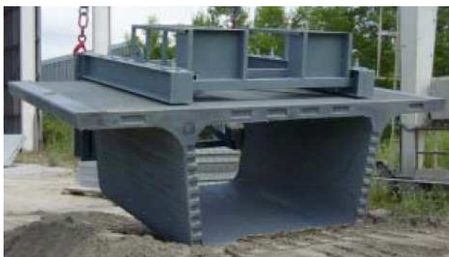
Figure 7 : élément témoin échelle 1 pour le pont PS34 en BCV®, avec schéma des prélèvements effectués Figure 7: full scale mock-up of the PS34 overpass in BCV®, with the scheme of extracted samples
