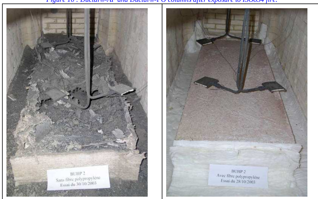
Figure 11 : Eproutette de BFUP CERIB UHPC II sans fibre (gauche) et avec fibre (droite) après exposition au feu ISO834.
