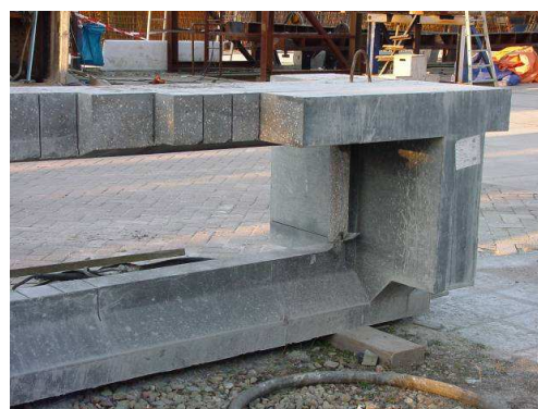
Figure 9 : élément témoin pour le pont de Bourg les Valence en BSI®, vue avant et après sciage Figure 9: mock-up of the Bourg les Valence bridge in BSI®, before and after sawing
