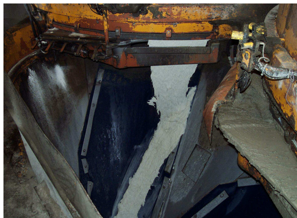
Bild 4.1: Herstellung von ultrahochfestem Beton im Tellermischer
