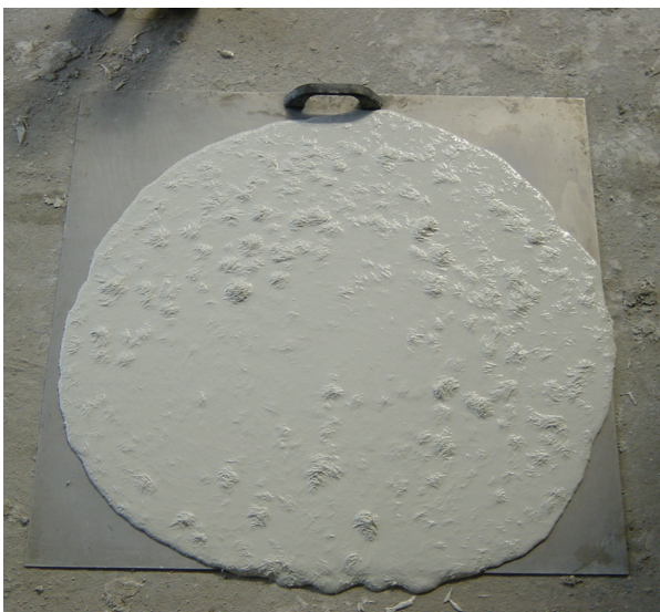
Bild 4.5: Entmischen eines UHFB bei zu hoher Fließmitteldosierung und Temperatur
