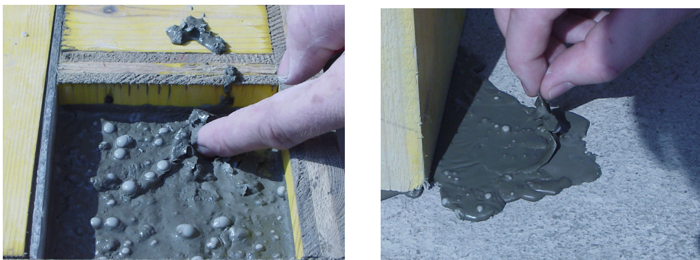
Bild 4.10: Bildung einer sog. „Elefantenhaut“ bei unsachgemäßer Nachbehandlung der freien Oberfläche (direkte Sonneneinstrahlung)
