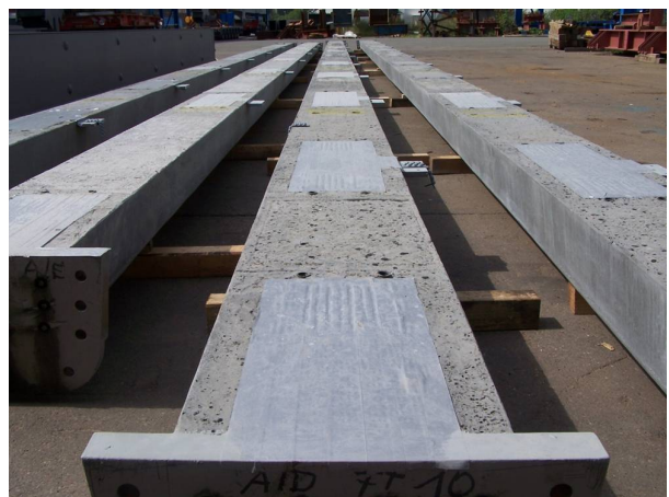
Bild 2.21: Fahrbahnplatten (links) und vorgespannte Obergurte nach der Herstellung im Fertigteilwerk (Firma ELO Beton)
