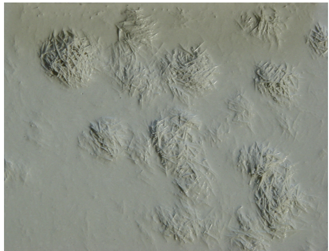
Bild 4.5: Entmischen eines UHFB bei zu hoher Fließmitteldosierung und Temperatur
