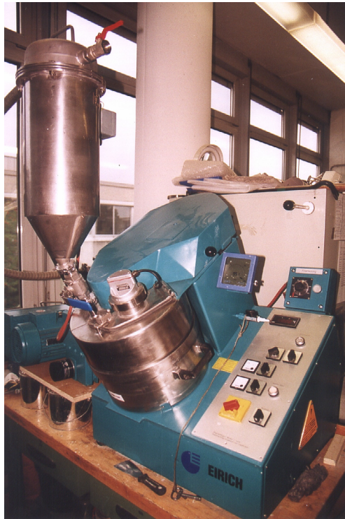
Bild 4.4: Vakuummischer zur Herstellung von UHFB
