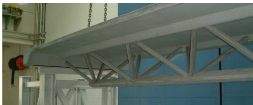
Bild 2.24: Modellbrücke der Firma Bögel mit Raumfachwerk aus vorgespannten UHFB-Stäben [2.31]
