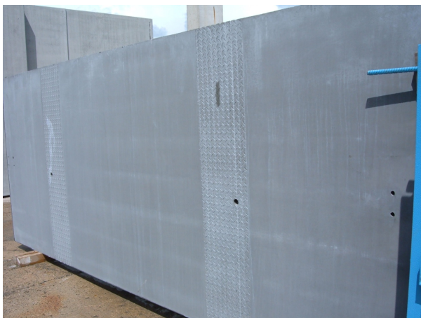
Bild 2.21: Fahrbahnplatten (links) und vorgespannte Obergurte nach der Herstellung im Fertigteilwerk (Firma ELO Beton)
