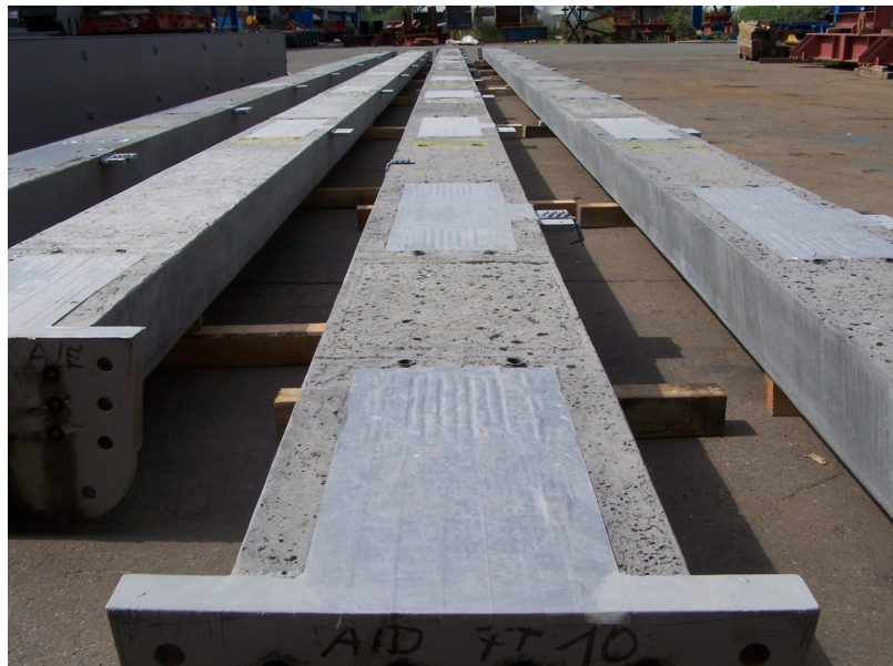
Bild 4.9: Obergurte nach der Wärmebehandlung
