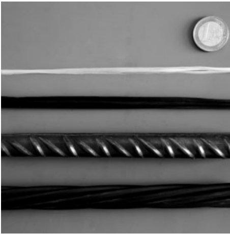
Bild 3. Größenvergleich für Bewehrungen; von oben nach unten: Glasfaser, Carbonfaser, Bewehrungsstahl 14 mm, Spannlitze 150 mm 2
