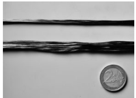
Bild 13. Größenvergleich mit einer 800-tex-Carbonfaser (low-tow, 12-k-Faser) und einer 3500-tex-Carbonfaser (heavy-tow, 50-k-Faser)
